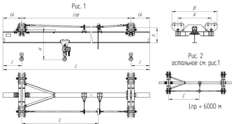
Краны подвесные ручные однобалочные предназначены для подъема и перемещения груза в помещениях или под навесом при температуре окружающей среды от -60°C до +45°C.
